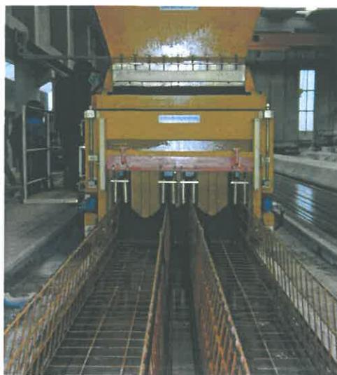
Figure 1. Vibratory finishing machine for the production of FORAP slabs/Macchina vibrofinitrice per la produzione delle lastre FORAP.
